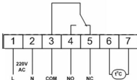
При снижении температуры рабочего датчика ниже настроенной, размыкается контакт NC и замыкается контакт NO.
